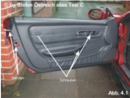
Schrauben lösen, dann die Blende um das Schloss entfernen, diese ist mit einer Kreuzschlitzschraube befestigt. Dann die Blende oberhalb des Schlosses entfernen, diese ist mit zwei Innen-Torx befestigt (T08)
