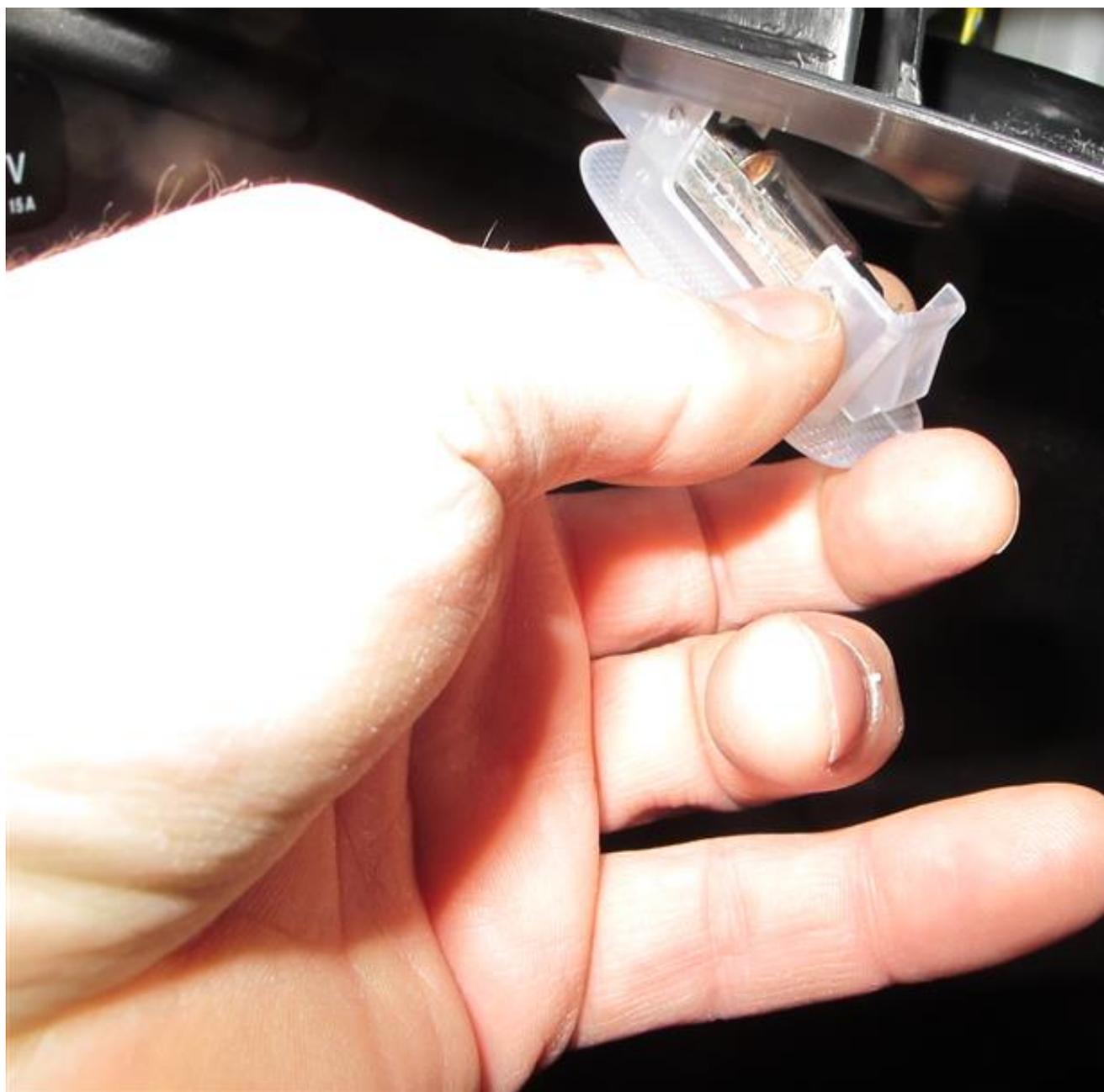
Remplacement de l'ampoule
